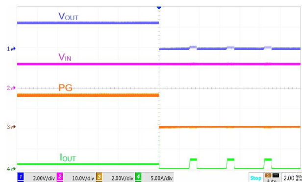
SCP进入 V_{IN}=12V , V_{OUT}=2.5V , I_{OUT}=1.2A
