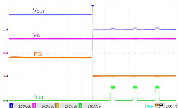
SCP进入 V_{IN}=12V , V_{OUT}=2.5V , I_{OUT}=0A
