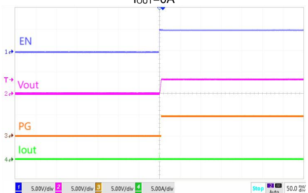
EN开机 I_{OUT}=0\text{A}
