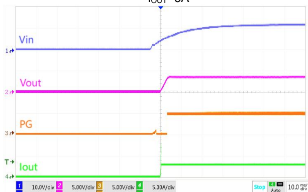
VIN开机 I_{OUT}=3\text{A}
